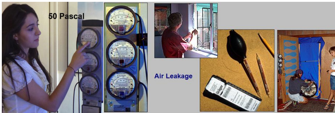
Fig. 12: The Blower Door experiment
