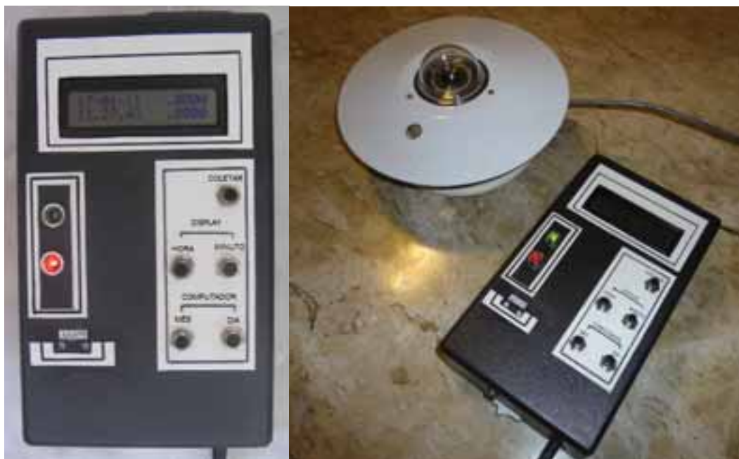
Figure 1 – Front view the mesurer and pyranometer spectral Vista frontal do coletor de dados e o sensor para medição da radiação global.
