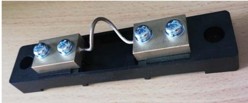
Figure 2.- Shunt 15 A / 150 mV.
