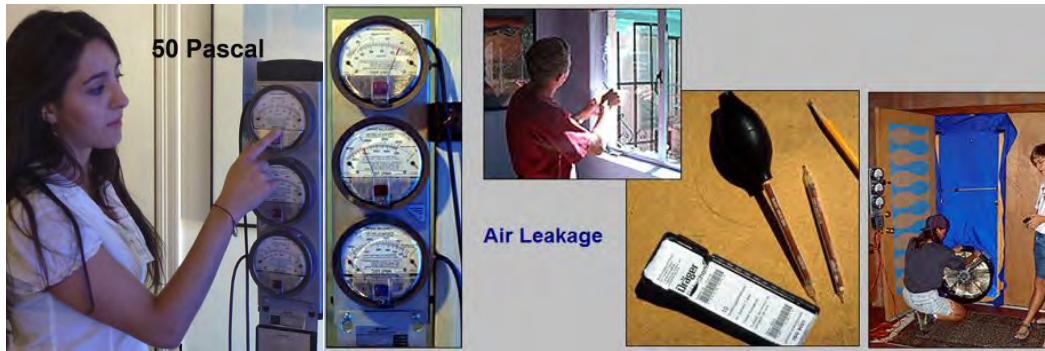
Fig. 12: The Blower Door experiment
